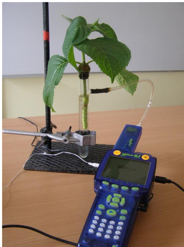
1 pav. Augalo šakelė prakišta pro guminį kamštį ir įmerkta į mėgintuvėlį su atšaka. Ant vandens paviršiaus užpiltas plonas aliejaus sluoksnis. Kamštis sandariai užkimštas ir hermetizuotas. Atšaka skaidraus plastiko vamzdeliu greito prijungimo-atjungimo jungtimi sujungta su slėgio jutikliu. Pastarasis prijungtas prie GLX'o.
