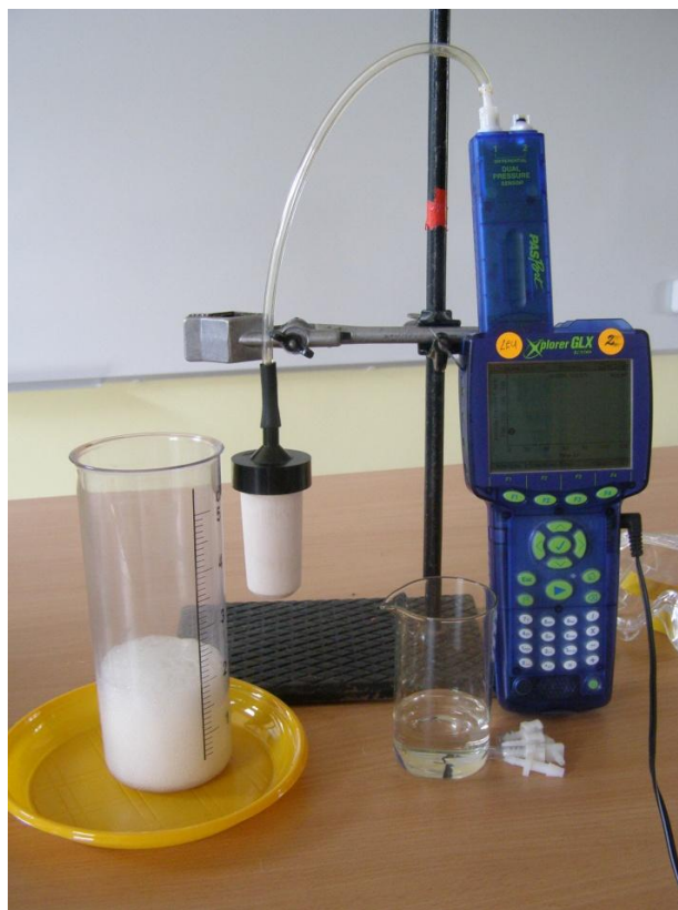
5 b pav. Ant kreidos gabalėlių užpildus druskos rūgšties, vyksta reakcija, kurios metu gaminasi anglies dioksidas (CO 2 ). Akytąjį indą į stiklinę įleiskite taip, kad jo dugnas nelieštų putų.
