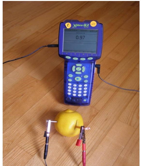
4 pav. Vario (Cu) ir cinko (Zn) elektrodai įsmeigti į citriną. Šis elektrocheminis elementas (galvaninis elementas) sukūrė 0,97 V elektrovarą. Duomenys šiuo atveju buvo atvaizduoti skaitmeniniame ekrane.
