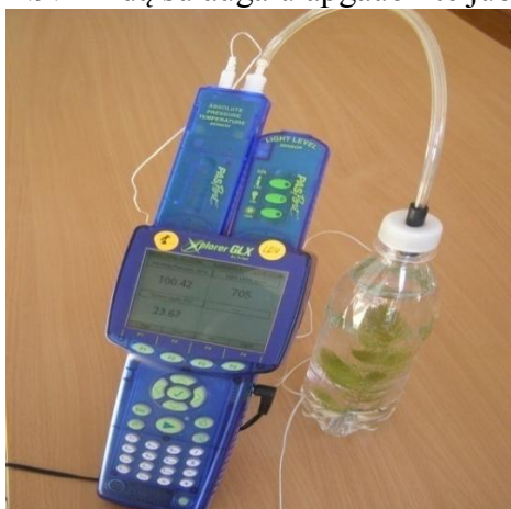
1 pav. GLX'as su apšvietos ir slėgio-temperatūros jutikliu. Į pastarojo temperatūros lizdą įjungtas didelės spartos temperatūros jutiklis / zondas. Slėgio lizdas vamzdeliu su greito prijungimo-atjungimo gnybtu sujungtas su indu, kuriame vandenyje panardintas augalas. GLX'o skaitmeniniame displejuje vienu metu matome pradinį slėgį, apšvietimą ir temperatūrą.
